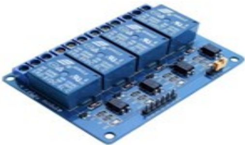
Figura 7. Módulo Relé 4 Canales. Fuente: [21]
