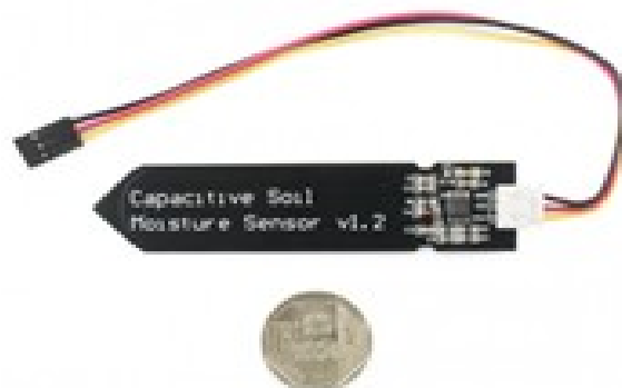
Figura 3: Sensor de humedad de suelo capacitivo V1.2. Fuente: [13]
