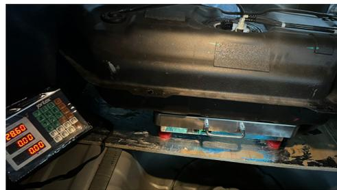
Figura 3: Medición de peso del combustible
