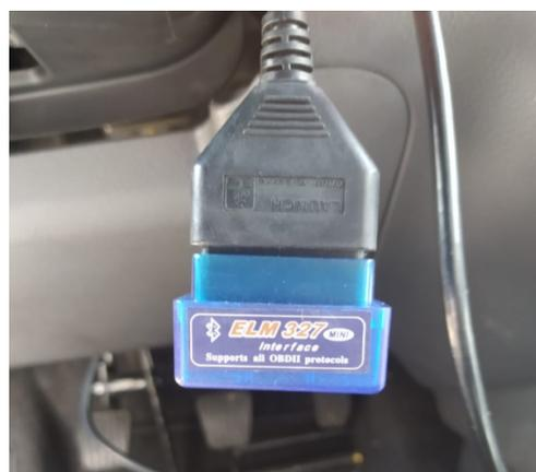
Figura 4: Conexión del Escáner ELM327
