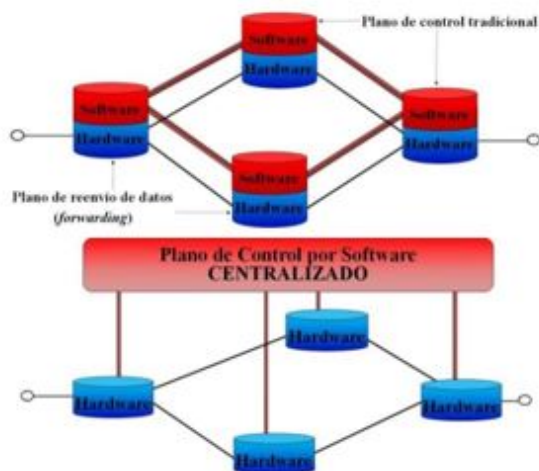
Figura 7: Superior: Plano de datos y control distribuidos y co-localizados en una red tradicional; Inferior: Plano de control centralizado en una SDN.
