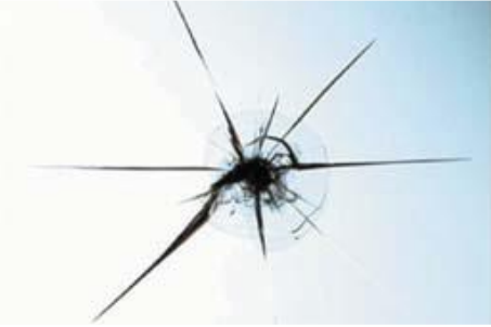
Figura 7: Rotura con grieta Fuente: Carglass 2009
