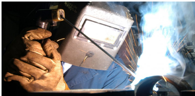
Figura 4.4: Soldadura con Arco.
