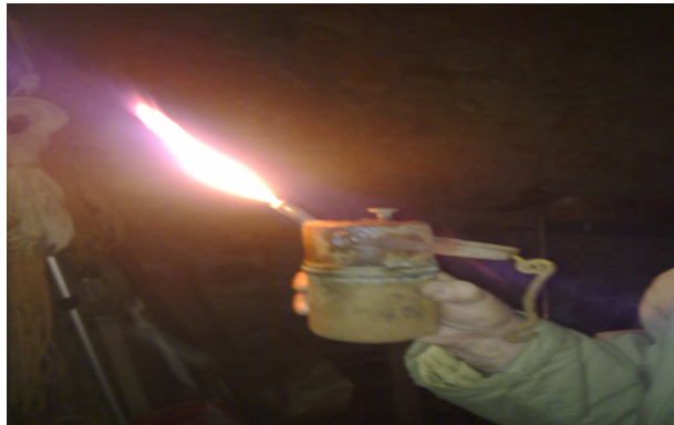
Figura 4.3: Llama Carburante. Fuente: Wikimedia Commons (2017)
