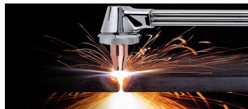
Figura 4.1: Llama Neutra. Fuente: La soldadura Oxi-acetilénica (2017)
